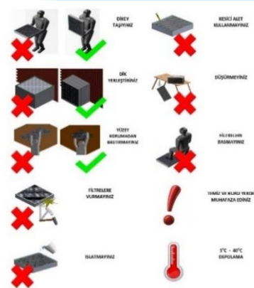
Şekil40. Filtrelerle çalışılırken dikkat edilmesi gereken hususlar
